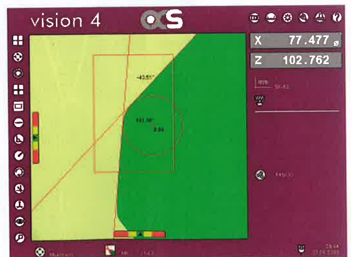
Der 12.1 Zoll grosse Alfa-Set-Touchscreen dient als Messplattform und kann für verschiedenste Messungen an der Schneide eingesetzt werden.
