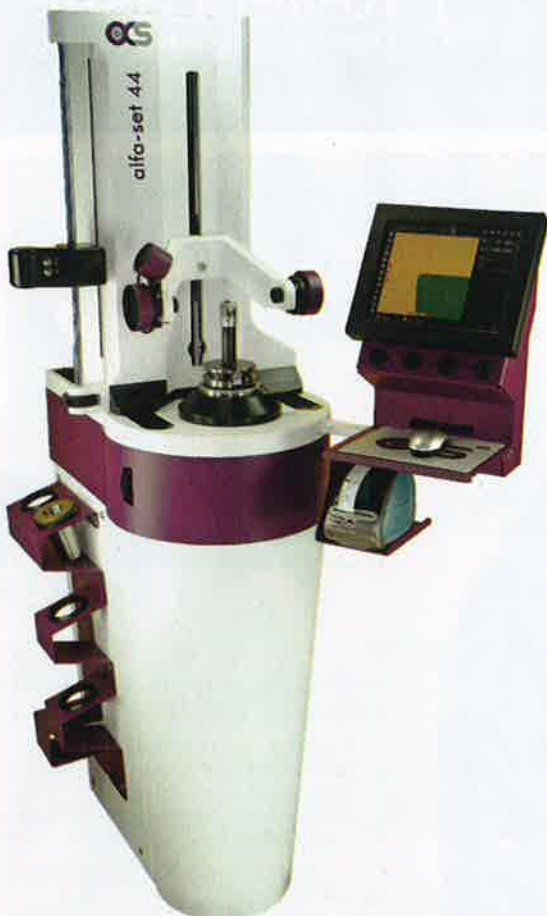
Die Alfa-Set-«Vision»-Geräte sind mit Farbkamera und Touchscreen ausgerüstet. Die Schneidposition in X und Z wie auch Winkel und Radien können über ein virtuelles Fadenkreuz vermessen werden.
