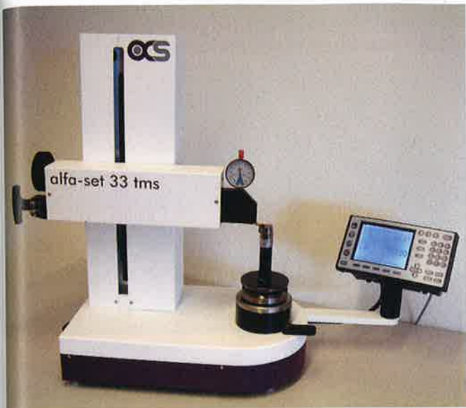
Das Voreinstellgerät Alfa-Set 33 ist für einfachere Anwendungen in der Werkzeug-Voreinstellung konzipiert.
